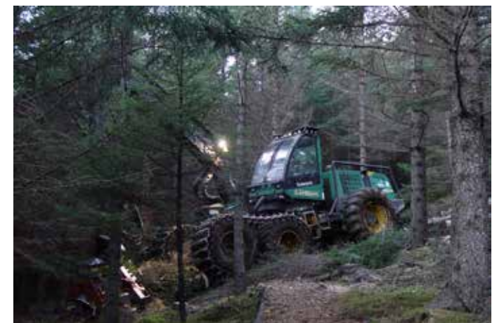
Daninn grisjar sitkagreni í Skorradal á Timberjack skógarhöggsvél_Mynd Hreinn Óskarsson
