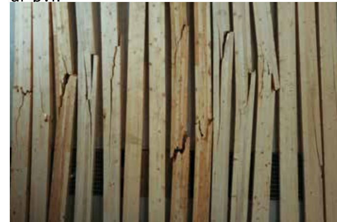
Allir 15 límtrésbitarnir eftir álagspróf. Fyrstu tveir bitarnir eru fura, síðan koma lerki, ösp, sitkagreni, sænskt rauðgreni, fura, tveir lerkibitar, tvær aspir, tvö sitkagreni og tvö sænsk rauðgreni.
