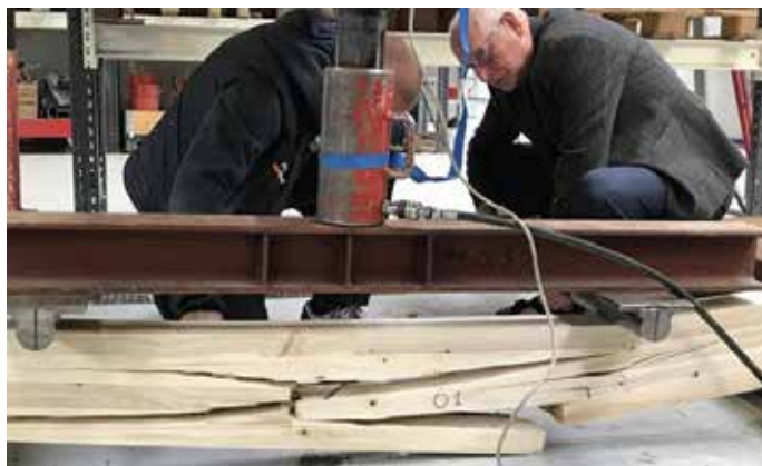
Eiríkur Þorsteinsson, trétæknir og verkefnisstjóri verkefnisins, skoðar ösp undir álagstjakki.
