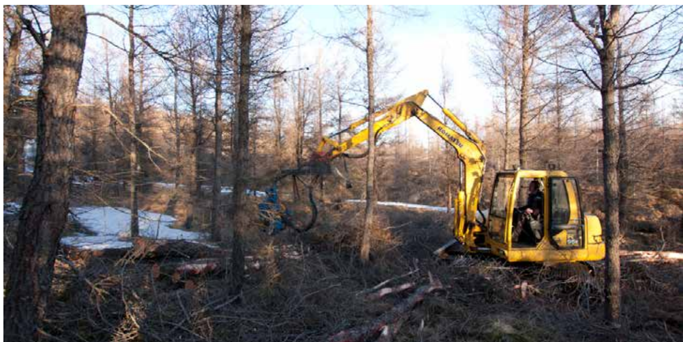
Keto-högghausinn hefur komið að sögun á Hallormsstað í um áratug_ Mynd Þór Þorfinnsson
